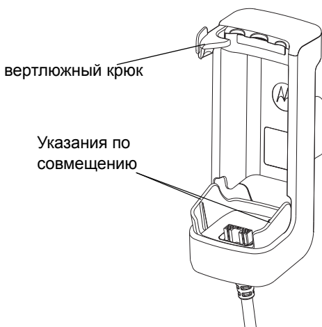
Рис. 1. Зарядная станция PMLN6182 с автомобильным модулем питания.
